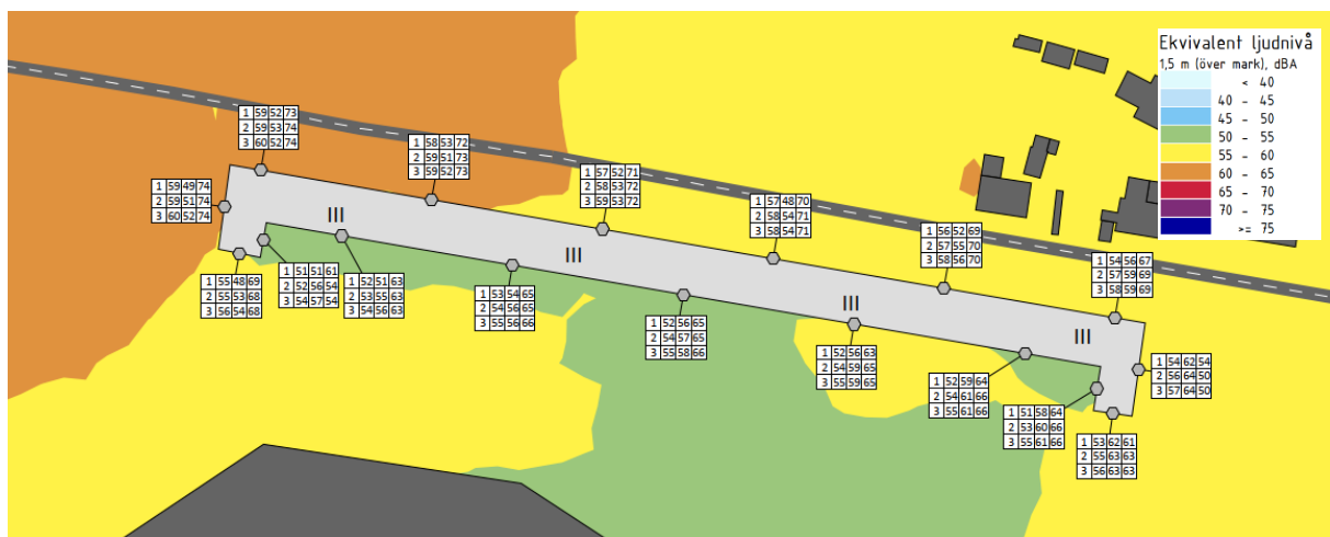
Figur 2. Urklipp från AK01. Beräknade trafikbullernivåer för prognosår 2040. Tabellerade värden är frifältsvärden och avläses "Våning / Leq / Lmax väg / Lmax järnväg".
